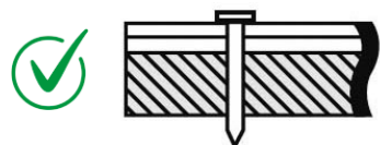
Рис. 2. Пример правильной забивки гвоздей при монтаже продукции.
