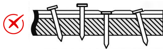
Рис. 3. Пример неправильной забивки гвоздей при монтаже продукции.
